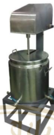
ภาพที่ 15 แสดงเครื่องผสมหรือกวนสารเคมีขนาด 50 ลิตร
