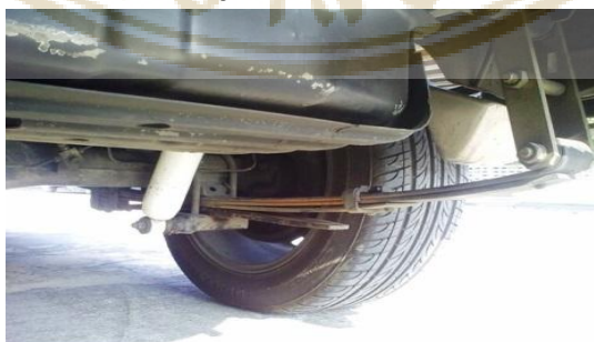
ภาพที่ 13 ตรวจสอบเช็คสภาพแหนบว่าใช้ได้ถึงขนาดไหนโดยการตัด
