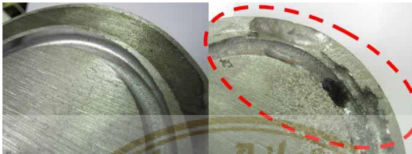
ภาพที่ 11 ในการตรวจสอบลูกสูบหาพบข้อบกพร่องดังกล่าวจะเปลี่ยนเป็นของใหม่ทันที
