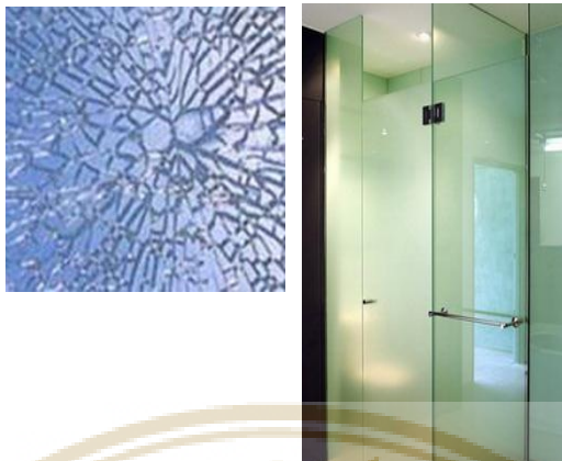
ภาพที่ 1.7 แสดงตัวอย่างกระจกนิรภัย และการแสดงรอยร้าวในกรณีที่เกิดการแตก
