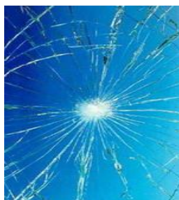
ภาพที่ 2.7 แสดงตัวอย่างรอยร้าวในกรณีที่เกิดการแตกของกระจกลามิเนต
