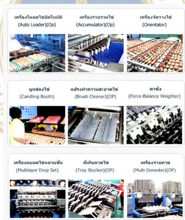
ภาพที่ 1.6 เครื่องคัดไข่และบรรจุไข่ NABEL
