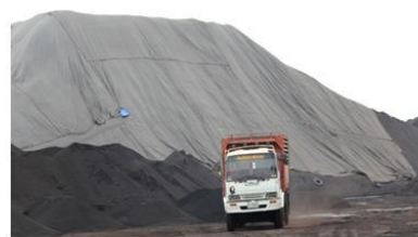
ผ้าใบปิดคลุมกองถ่านหิน
