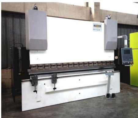
ภาพที่ 5.3 แสดงภาพเครื่องขึ้นรูปโลหะด้วยการพับ 2 เครื่อง
