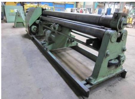
ภาพที่ 5.4 แสดงภาพเครื่องขึ้นรูปโลหะด้วยการม้วน 2 เครื่อง
