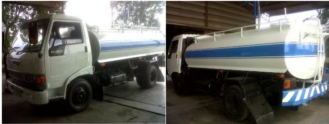
ภาพที่ 3.3 ตัวอย่างรถบรรทุกน้ำ 6 ล้อ โดยขนย้ายน้ำแร่ได้ครั้งละ 6,000 ลิตร
