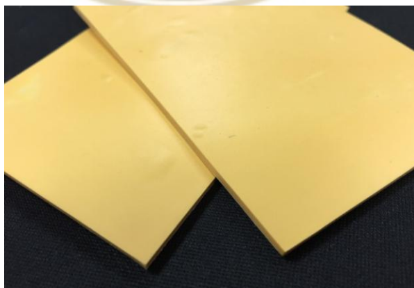
ภาพที่ 1.11 สารเคมีผงฟูหรือยาพอง (Blowing Agent) แบบแผ่น (Sheet) ที่มา : ฝ่ายขายและการตลาดบริษัท เอ.เอฟ.เอส. จำกัด
