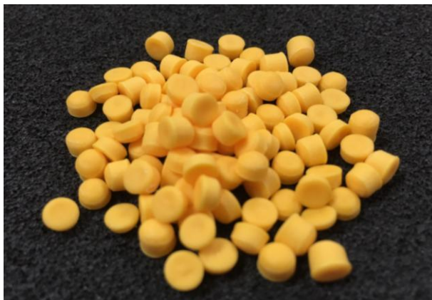
ภาพที่ 1.9 สารเคมีผงฟูหรือยาพอง (Blowing Agent) แบบเม็ด (Masterbatch) ที่มา : ฝ่ายขายและการตลาดบริษัท เอ.เอฟ.เอส. จำกัด
