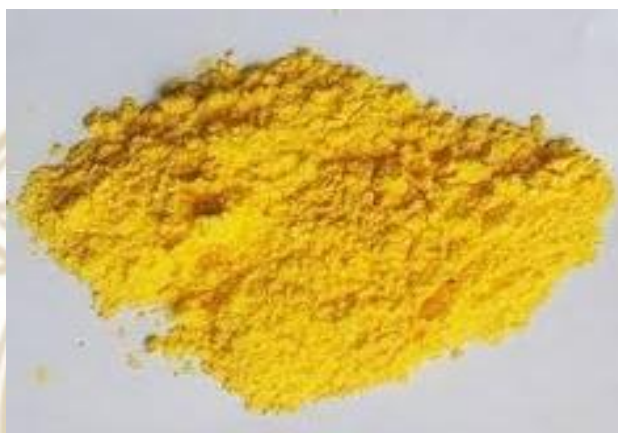
ภาพที่ 1.7 สารเคมีผงฟูหรือยาพอง (Blowing Agent) แบบผง (Powder)
