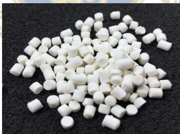
ภาพที่ 1.8 สารเคมีผงฟูหรือยาพอง (Blowing Agent) แบบเม็ด (Masterbatch)
