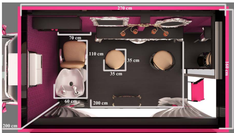
ภาพที่ 2.5 รูปแบบรถภายในและองค์ประกอบต่างๆ ภายในรถพร้อมทั้งขนาด
