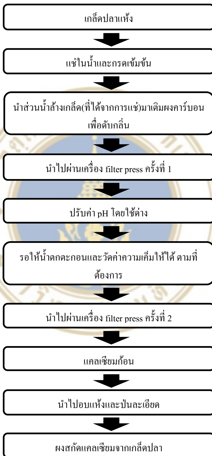
ภาพที่ 3.2 แสดงขั้นตอนการผลิตแคลเซียมจากเกล็ดปลา
