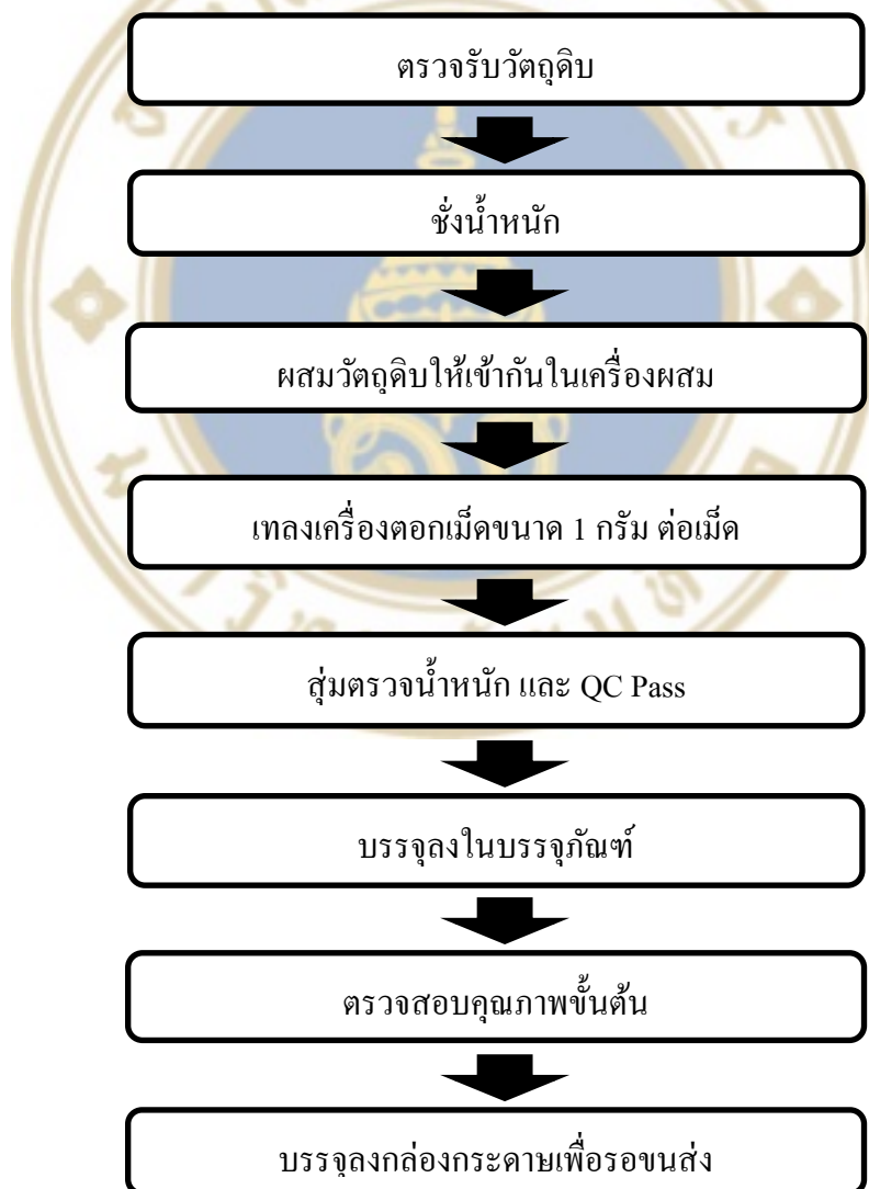
ภาพที่ 3.4 แสดงขั้นตอนการผลิตผลิตภัณฑ์เสริมอาหารแคลเซียมจากเกลือปลา ตรา “CALMATE”
