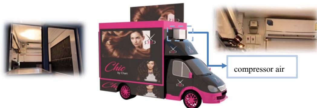
ภาพที่ 1.14 แสดงระบบเครื่องปรับอากาศ
