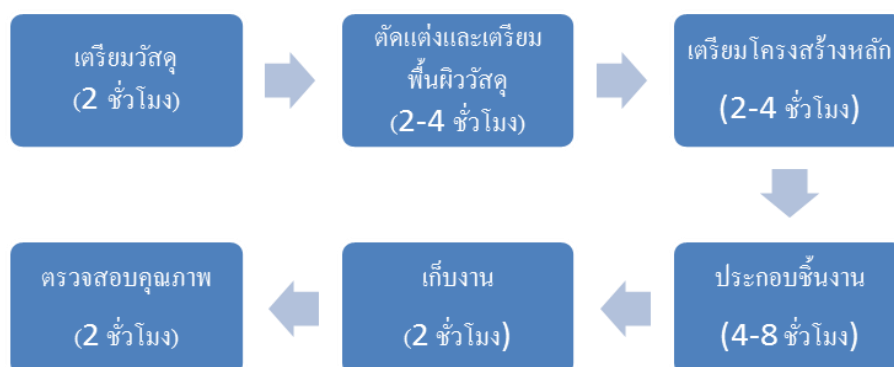
ภาพที่ 3.4 ขั้นตอนการผลิตบ้านสำหรับสัตว์เลี้ยงของ Pet Society
