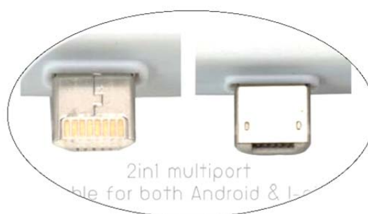
ภาพที่ 1.6 มัลติพอร์ต ด้านหน้าและด้านหลัง
