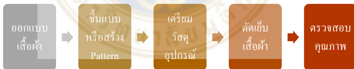
ภาพที่ 4.3 แสดงแผนผังแสดงกระบวนการผลิตสินค้า
