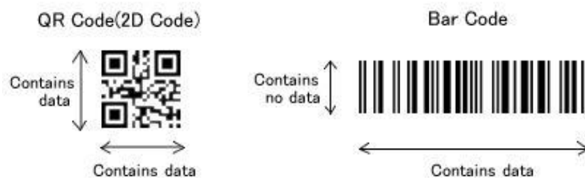
ภาพที่ 1.3 ภาพเปรียบเทียบระหว่าง QR CODE (2D CODE) และบาร์โค้ดธรรมดา (ที่มา: www.qrcode.com , 2553)
