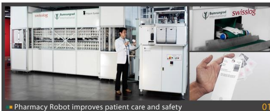
รูปภาพที่ 1.3 หุ่นยนต์จัดจ่ายยาอัตโนมัติสำหรับผู้ป่วยในแบบ unit dose
