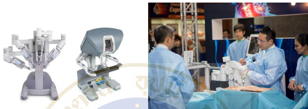
รูปภาพที่ 1.1 หุ่นยนต์ผ่าตัด da Vinci (ซ้าย) และแขนกลหุ่นยนต์กำหนดพิกัดผู้ช่วยศัลยแพทย์ผ่าตัดกระดูกสันหลัง (ขวา)
