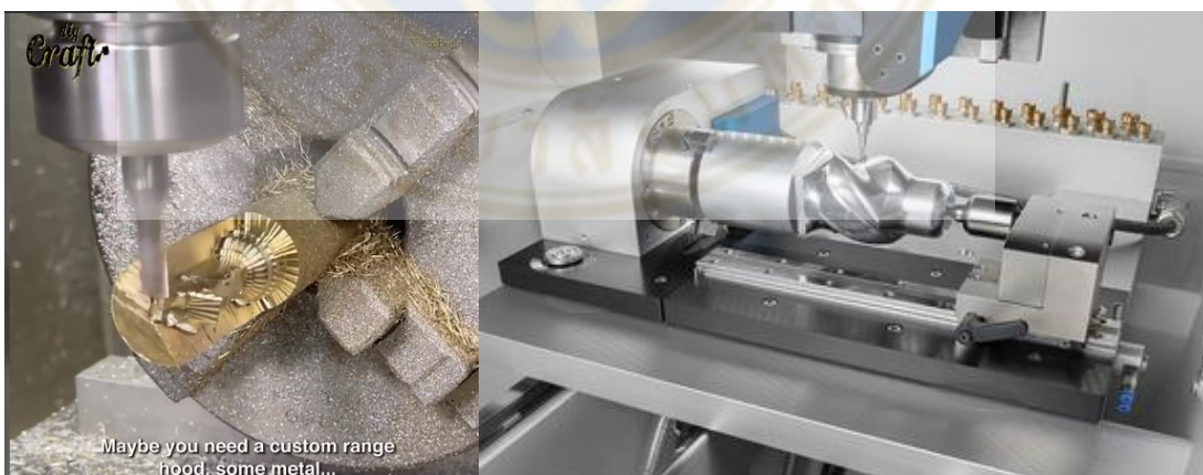
รูปภาพที่ 4.18 ตัวอย่างการแกะสลัก (ด้วยเครื่อง CNC)
