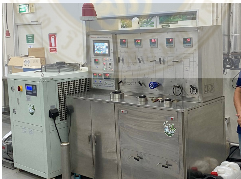
ภาพที่ 4. 5 อุปกรณ์ในการสกัดสารสำคัญจากช่อดอกกัญชง
