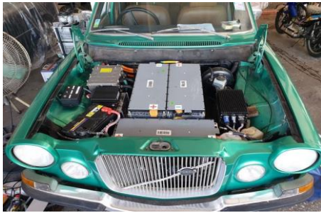
รูปภาพที่ 2.4 แสดงตัวอย่างของการยกเครื่องในการเปลี่ยนรถยนต์ธรรมดาให้กลายเป็นรถยนต์ไฟฟ้า (Magcarzine ,2565)
