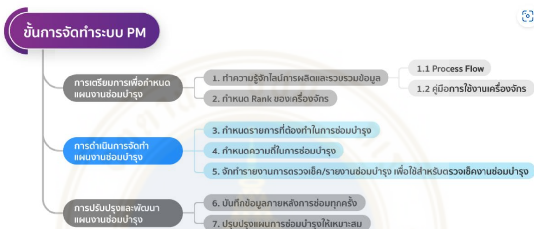
รูป 3.3 ขั้นตอนการจัดทำระบบแผนซ่อมบำรุงเชิงป้องกัน
