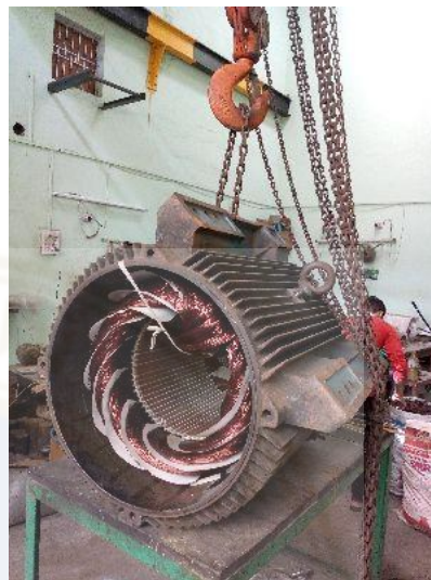
รูป 1.3 ภาพการซ่อมมอเตอร์และนำไปติดตั้งบนแพกลางบึงน้ำ
