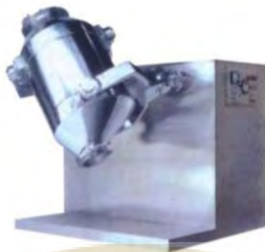
ภาพที่ 5 แสดงลักษณะเครื่องจักรสำหรับเหวี่ยงผสมสารสำคัญ
